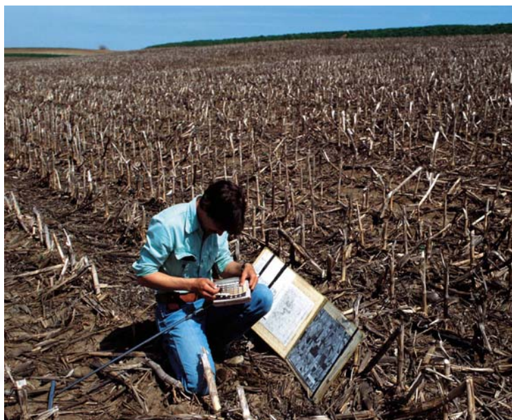
Φωτογραφία 2.1. Περιγραφή εδαφικού δείγματος και λήψη της θέσης του φρεατίου με GPS
