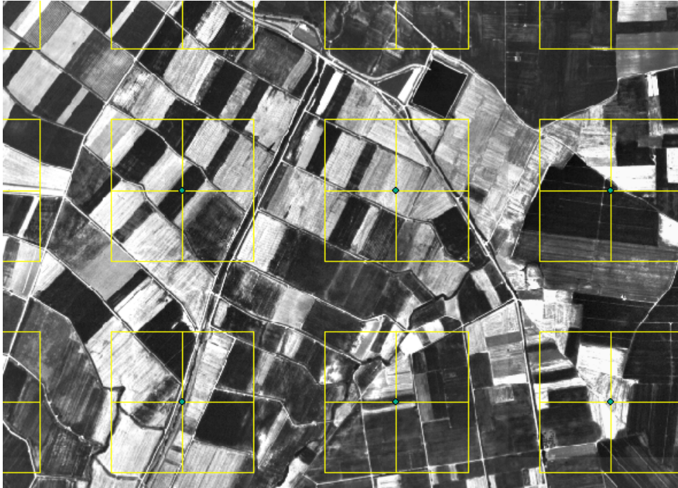
Εικόνα 1.2. Αυτοματοποιημένη διαδικασία δημιουργίας κανάβου σε προβολικό σύστημα ΕΓΣΑ87 και υπέρθεση του στην υπό χαρτογράφηση περιοχή. Στο κάθε τετράγωνο διανοίγονται 9 φρεάτια σε βάθη 0-30, 30-60 και >60 εκ. και συγχωνεύονται στο κεντρικό φρεάτιο, ομογενοποιούνται και έτσι τελικά από κάθε τετράγωνο πραγματοποιούνται αναλύσεις μόνο στο κεντρικό φρεάτιο που αποτελεί ανάμιξη και των εννέα φρεατίων
