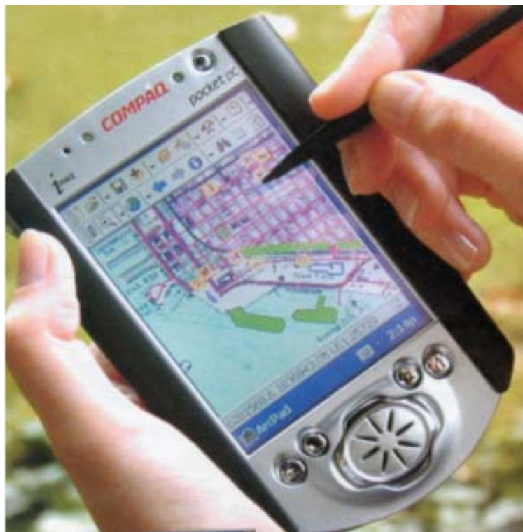
Φωτογραφία 2.2. Υπολογιστής τσέπης με GIS ArcPAD και GPS, για εργασίες υπαίθρου
