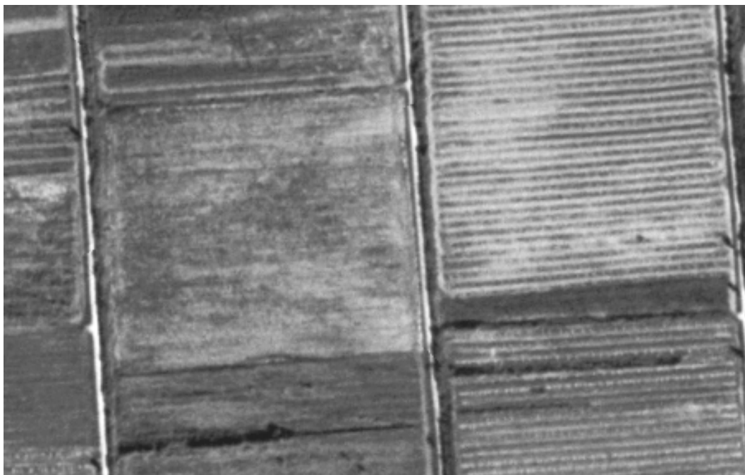
Εικόνα 1.18. Επιφανειακή διάβρωση (ανοικτός τόνος)
