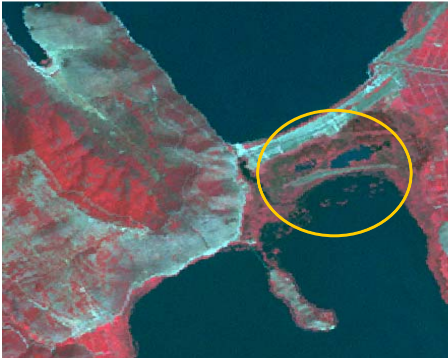
Εικόνα 1.16. Εδάφη με υψηλή υπόγεια στάθμη νερού στην περιοχή μεταξύ των λιμνών Μεγάλης και Μικρής Πρέσπας. Φαίνεται η διαφορά του τόνου (πιο σκούρος) σε σχέση με τις γειτονικές περιοχές.
