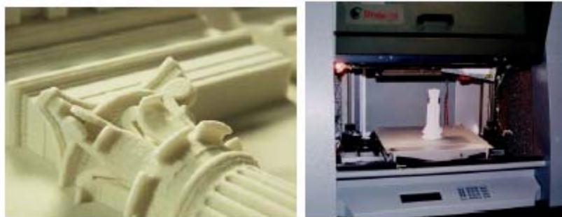
Εικόνα 29. Συσκευή εκτύπωσης με εναπόθεση υλικού (δεξιά) και δείγμα εκτύπωσης (αριστερά)
